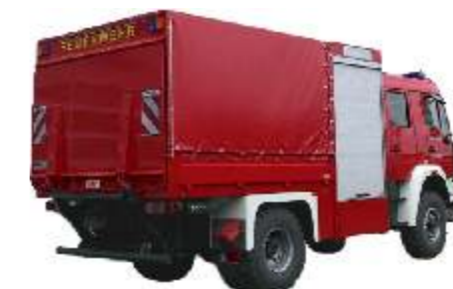
Beispiel für einen EMPL GW-L mit Planengestell und Alu-Staukästen
