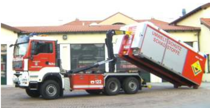
Wechseladefahrzeug mit Dekontaminationscontainer (WLF)
