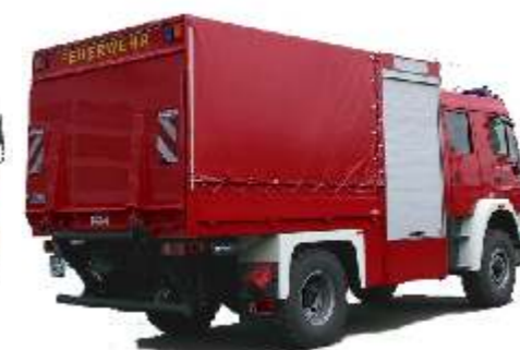
Beispiel für einen EMPL GW-L mit Planengestell und Alu-Staukästen
