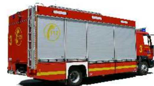
Beispiel für einen EMPL GW-G mit kompletten Kofferaufbau
