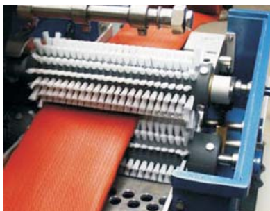
Kurze, harte Borsten ermöglichen optimale Reinigung und lange Lebensdauer
