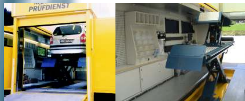
Hebebühne mit Rüttelplatte zur Achsspielüberprüfung Hydraulic lift with vibration plate for testing axle-slackness
